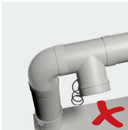
⚠ Geneigte Einbaulage unzulässig. Verdrehsicherung durch Abstützung erforderlich
