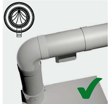
Einbaulage durch Siphon äußerlich erkennbar
