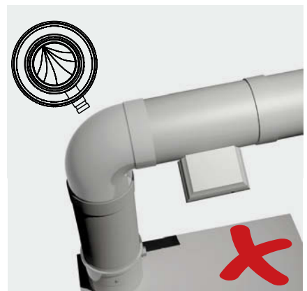
⚠ Falsche Einbaulage erkennbar durch Stellung des Siphons
