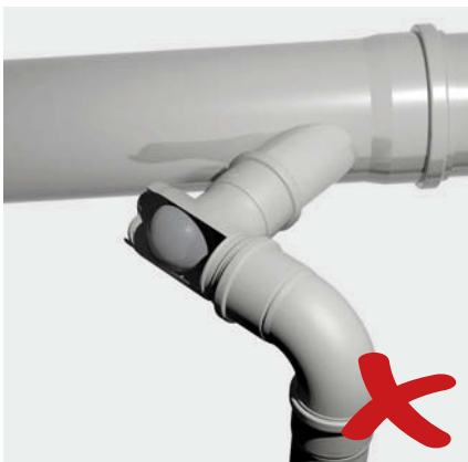
Waagerechte Einbaulage unzulässig
