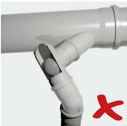
Diagonale Einbaulage unzulässig
