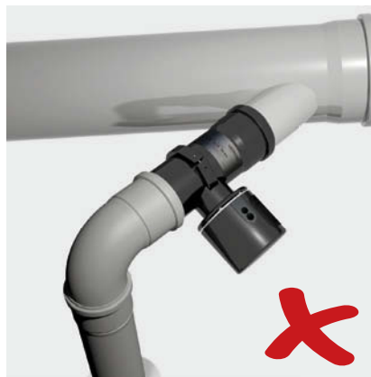
⚠ Geneigte Einbaulage unzulässig Verdrehicherung durch Abstützung erforderlich
